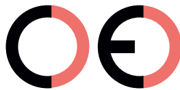
Marca CE falsa (demasiado separados)
